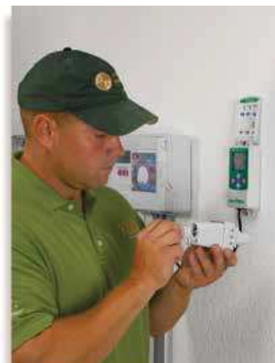
La sostituzione della batteria non richiede l'utilizzo di alcun attrezzo e non è necessario smontare il sensore
